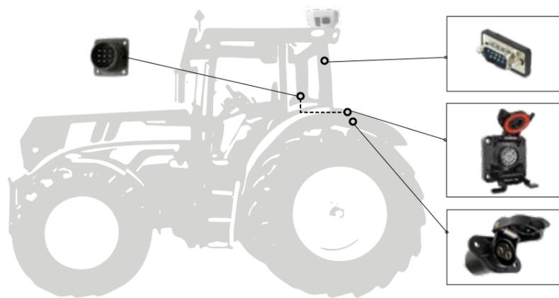
Der Schlepper ist bereits mit allen ISOBUS-Anschlüssen sowie einer InCab-Dose in der Schlepperkabine ausgestattet. Zusätzlich verfügt er über eine GPS-Antenne mit einer 9-poligen NMEA-Schnittstelle, die ebenfalls in der Kabine integriert ist.
