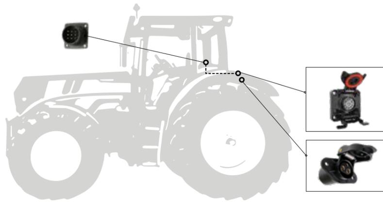
Der Schlepper verfügt bereits über alle ISOBUS Anschlüsse mit InCab-Dose in der Schlepperkabine.
