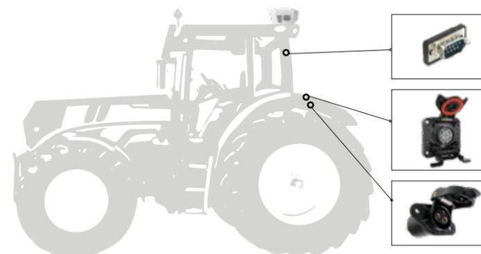
Der Schlepper verfügt über ISOBUS Anschlüsse mit GPS-Antenne (NMEA Schnittstelle)
