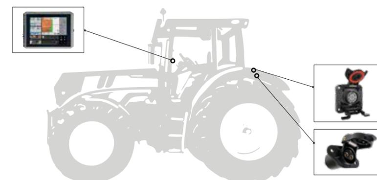
Der Schlepper verfügt über ISOBUS Anschlüsse und einen ISOBUS Universal Terminal.
