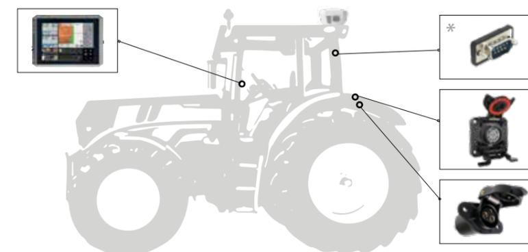
Der Schlepper verfügt über ISOBUS Anschlüsse, einen ISOBUS Universal Terminal und ein GPS-System.
