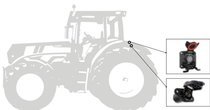
Der Schlepper verfügt über ISOBUS Anschlüsse
