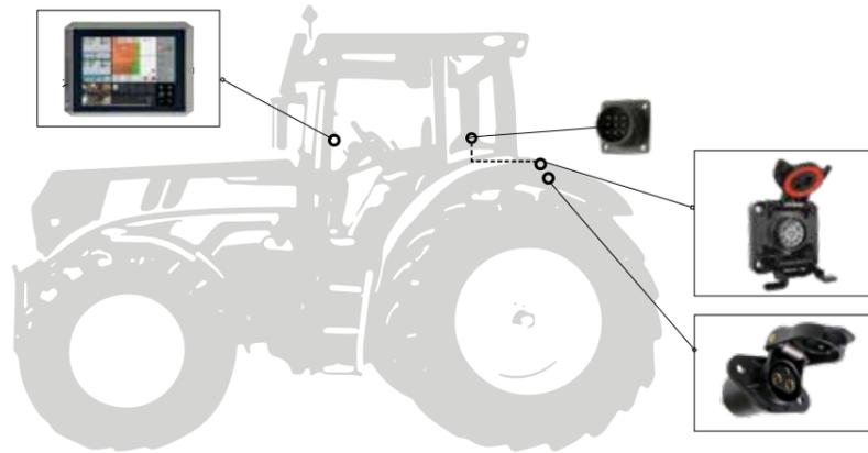
Der Schlepper verfügt über ISOBUS Anschlüsse und einen ISOBUS Universal Terminal.
