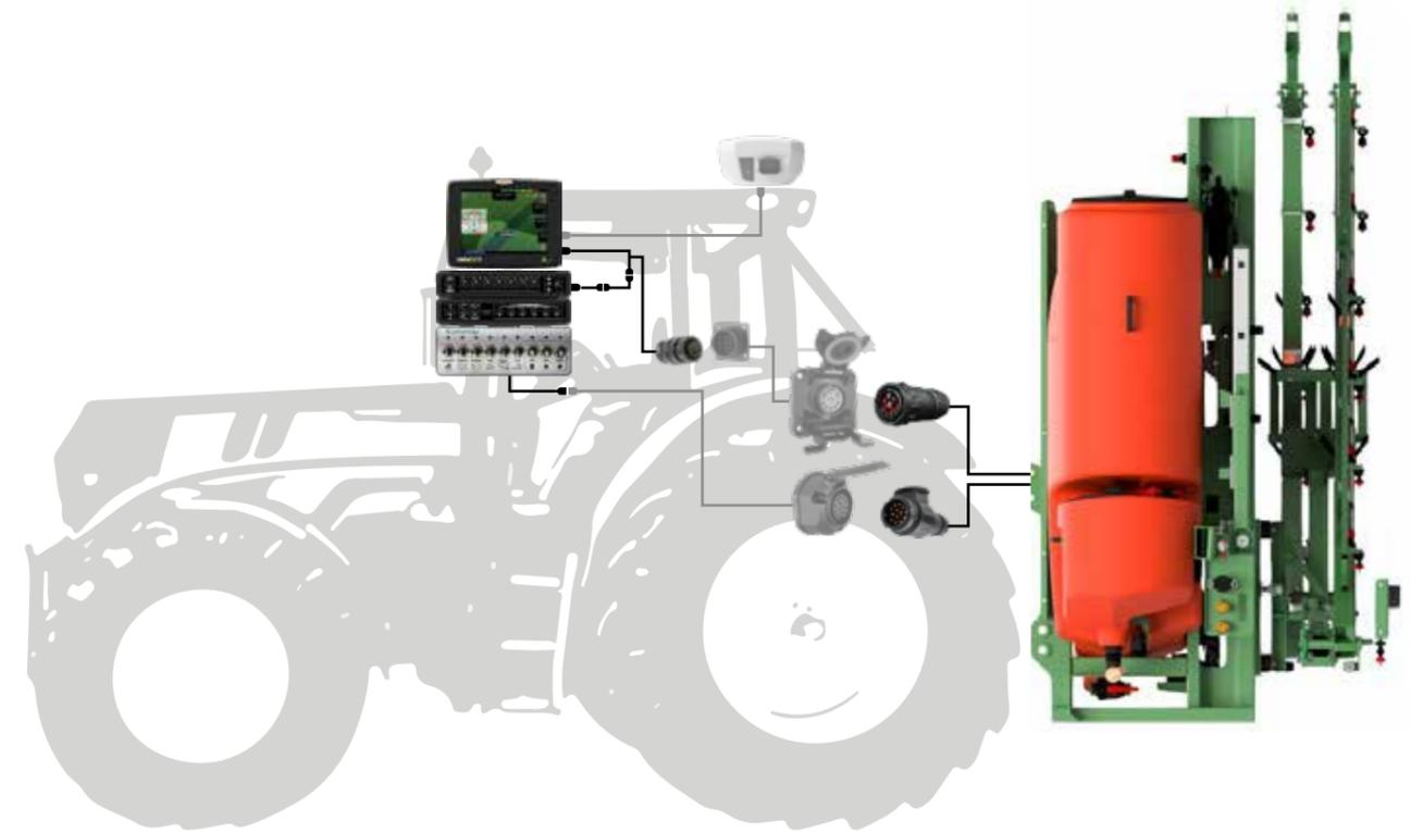
**Detaillierte Übersicht der Stecker- und Kabelverbindungen innerhalb der Schlepperkabine sowie außen am Traktor**
