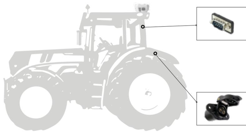
Der Schlepper verfügt bereits über eine GPS Antenne mit einer 9-poligen NMEA-Schnittstelle.
