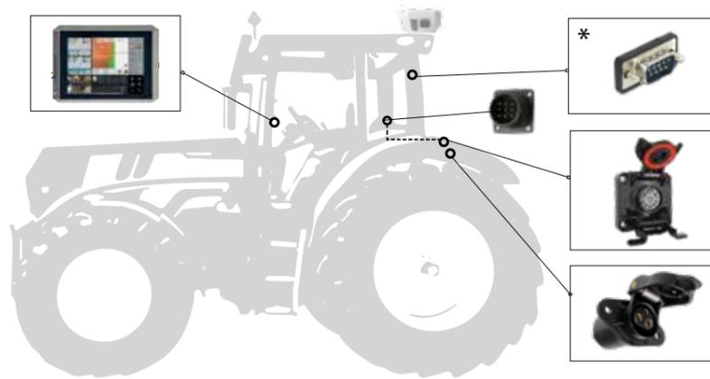
Der Schlepper verfügt über ISOBUS Anschlüsse, einen ISOBUS Universal Terminal und ein GPS-System
